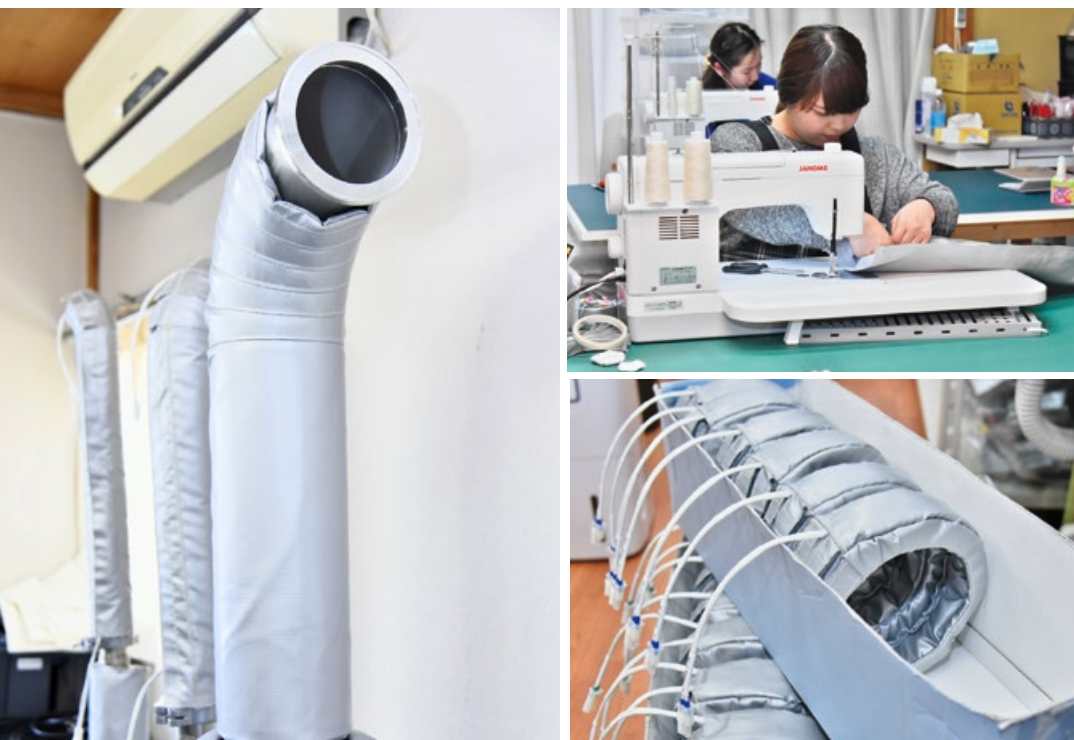
「ジェットヒーター」は配管のサイズに合わせ、ひとつひとつ採寸するオーダーメイドのため、あらゆる形状に対応が可能だ
